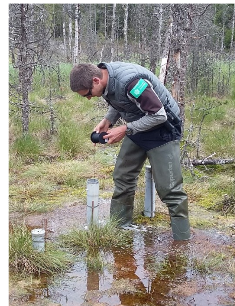
Installation d'une sonde dans un piézomètre G. MAGNON, 2021
